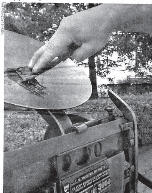
Najpierw trzeba talerz maszyny pokryć farbą drukarską, którą mechanizm urządzenia rozprowadzi po członkach i znakach typograficznych
